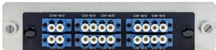
Além disso, o DM936 D8CH33 Mux/Demux DWDM possui uma porta de expansão (EXP) que pode ser utilizada para cascadeamento ou para a adição de um canal supervisorio de 1510nm (OSC). O seu formato compacto permite a sua instalação em um slot vago do DM4920 ou externamente em um rack de 19 polegadas com o adaptador MA-26.
