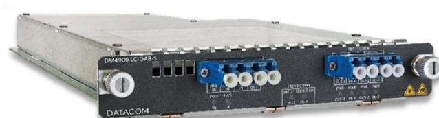
Os módulos proporcionam alta disponibilidade as redes ao permitir thresholds de chaveamento de proteção configuráveis por porta, ajustáveis entre -40dBm e 0dBm.
