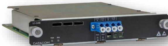
Os módulos DM4900 LC-OAC20 e LC-2xOAC20 possui dois modos de funcionamento: AGC (ganho constante) e APC (potência constante). O modo AGC é usado quando a potência de entrada é variável, enquanto o modo APC é usado quando a potência de entrada é fixa. Isso permite que o cartão se adapte às variações na potência de entrada e mantenha um sinal de saída estável e de alta qualidade.
